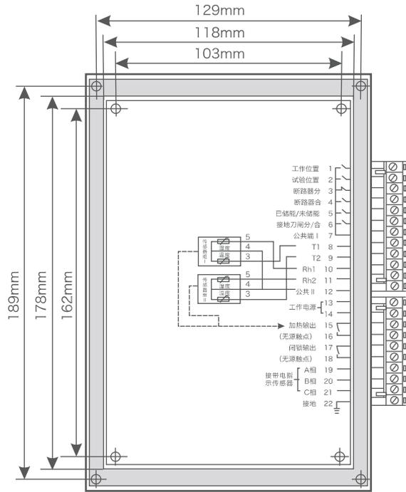
四个安装螺钉孔径 $\Phi 3.5$ ，孔距 $129\text{mm} \times 189\text{mm}$
